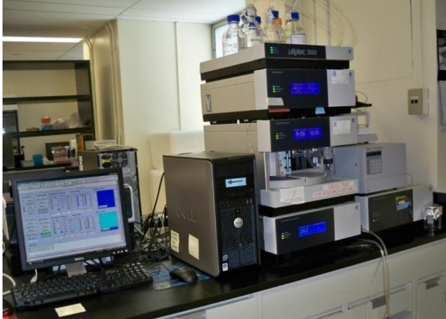
Hình 33: Một hệ thống sắc ký lỏng hiệu năng cao (HPLC) để phân tích hemoglobin của hồng cầu
