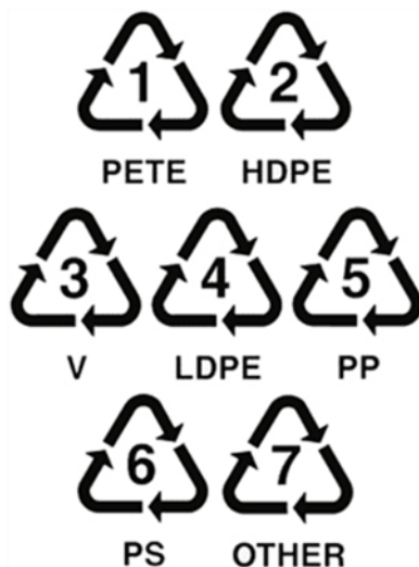
Hình 2: Ký hiệu các loại nhựa in ở đáy vật dụng bằng nhựa
