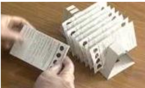
Hình 2: Sử dụng giấy cứng để làm thành giá phơi mẫu ngang hoặc dọc. Chú ý các mẫu giấy được phơi ngược chiều nhau
