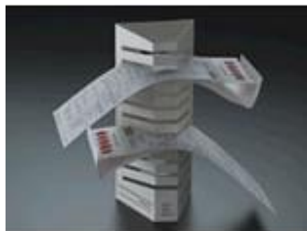
Hình 2: Sử dụng giấy cứng để làm thành giá phơi mẫu ngang hoặc dọc. Chú ý các mẫu giấy được phơi ngược chiều nhau
